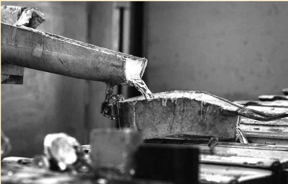
Слив миксера А81 (маркировка расплава алюминия)
